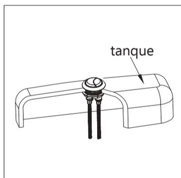
Instale o botão de acionamento no orifício da tampa da caixa acoplada e rosqueie a porca.
