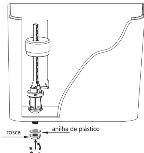
Desenrosque a porca e remova a anilha de plástico (opcional). Insira o mecanismo de entrada no orifício de instalação, no fundo da caixa, depois instale a anilha de plástico (opcional) e aperte a rosca.
