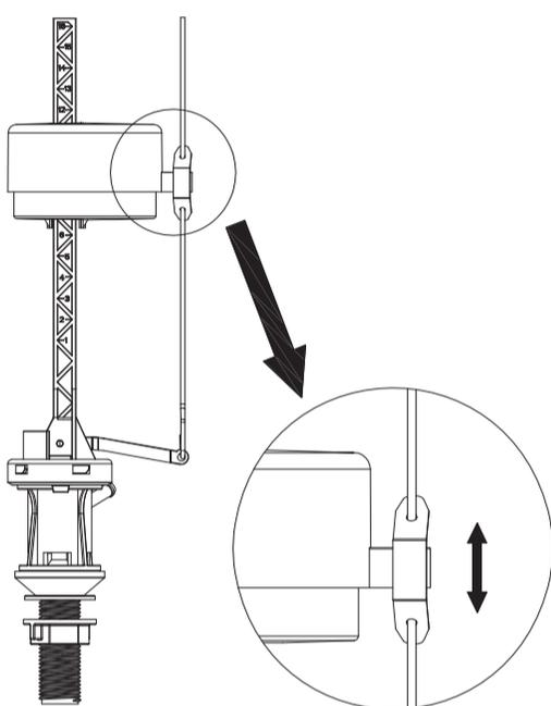
Pressione a parte de metal para ajustar o nível de água deslizando-a para cima (aumenta) e para baixo (diminui).
