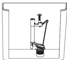
Desenrosque a porca e a anilha de plástico, ponha a válvula de descarga no orifício no fundo da caixa.
