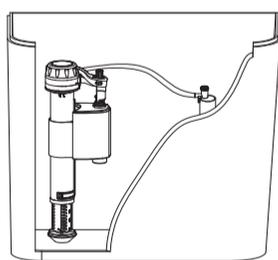
Conecte a mangueira do fecho hídrico no tubo de saída, conforme ilustrado (opcional) ou deixe solta dentro do tanque.
