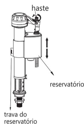
Solte a trava do reservatório deslocando-a no sentido anti-horário. Deslize o reservatório para cima ou para baixo para obter um fechamento rápido ou lento. Trave o reservatório deslocando a trava no sentido horário. Faça um ajuste fino girando a haste
